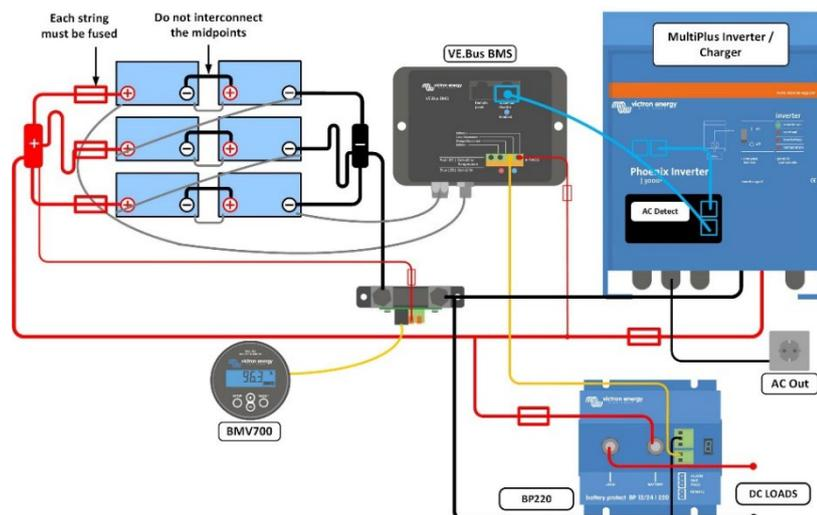
As nossas baterias LFP dispõem de monitorização e regulação das células integrada. Os cabos de regulação / monitorização podem ser ligados em margarida e devem ser conectados ao Sistema de Gestão de Baterias (BMS).
